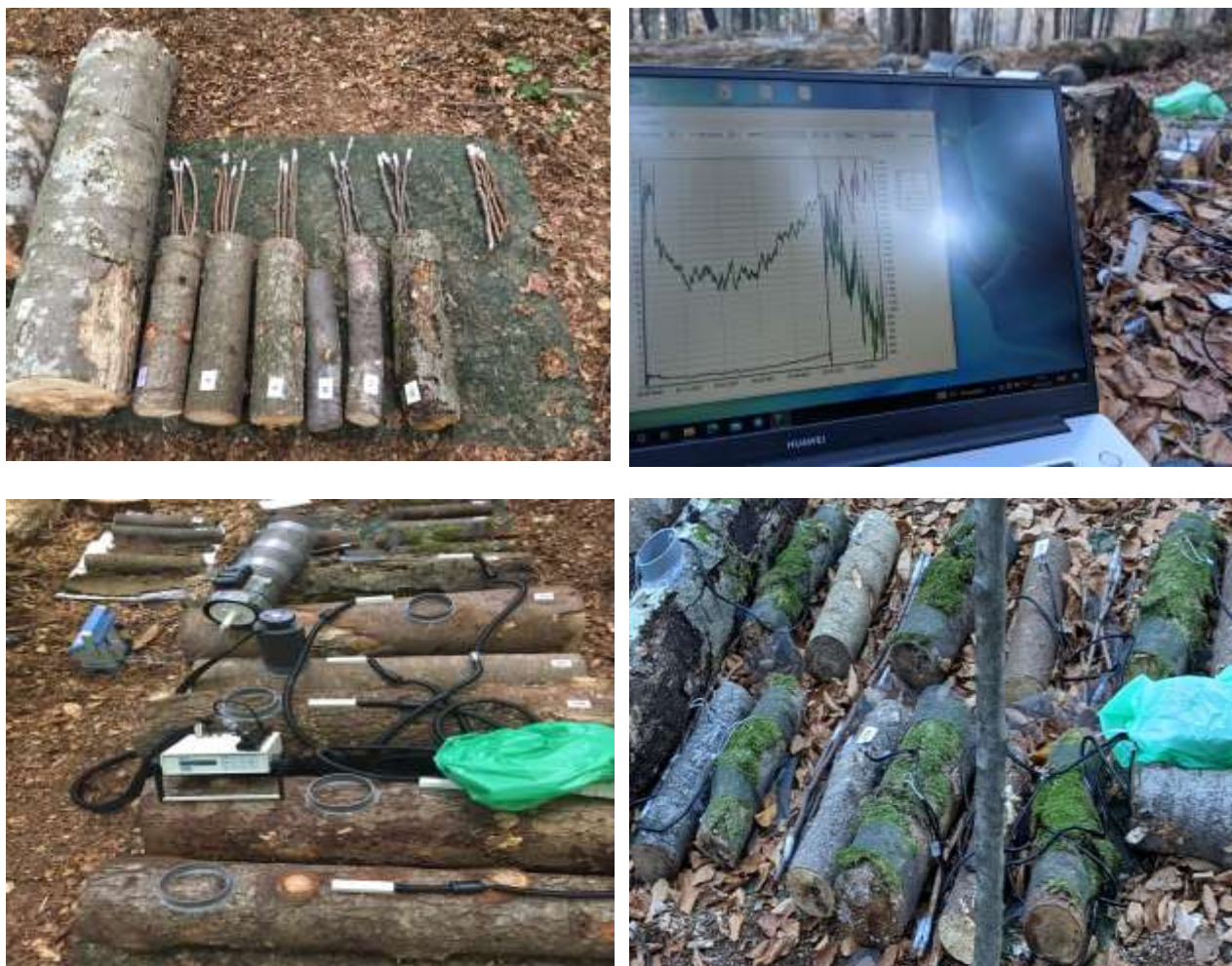
Figura 4. (a) Instalarea pieselor de 25 cm, 10 cm și 1 cm diametru; (b) Instalarea senzorilor de temperatură și umiditate pe trunchiurile de lemn mort și în sol; (c) Măsurarea fluxului de CO 2 folosind ERGM 4 și ERGM 5 cu diferite camere de respirație atașate; (d) instalarea senzorilor de temperatură și umiditate pe piesele de 10 cm acoperite cu mușchi.
