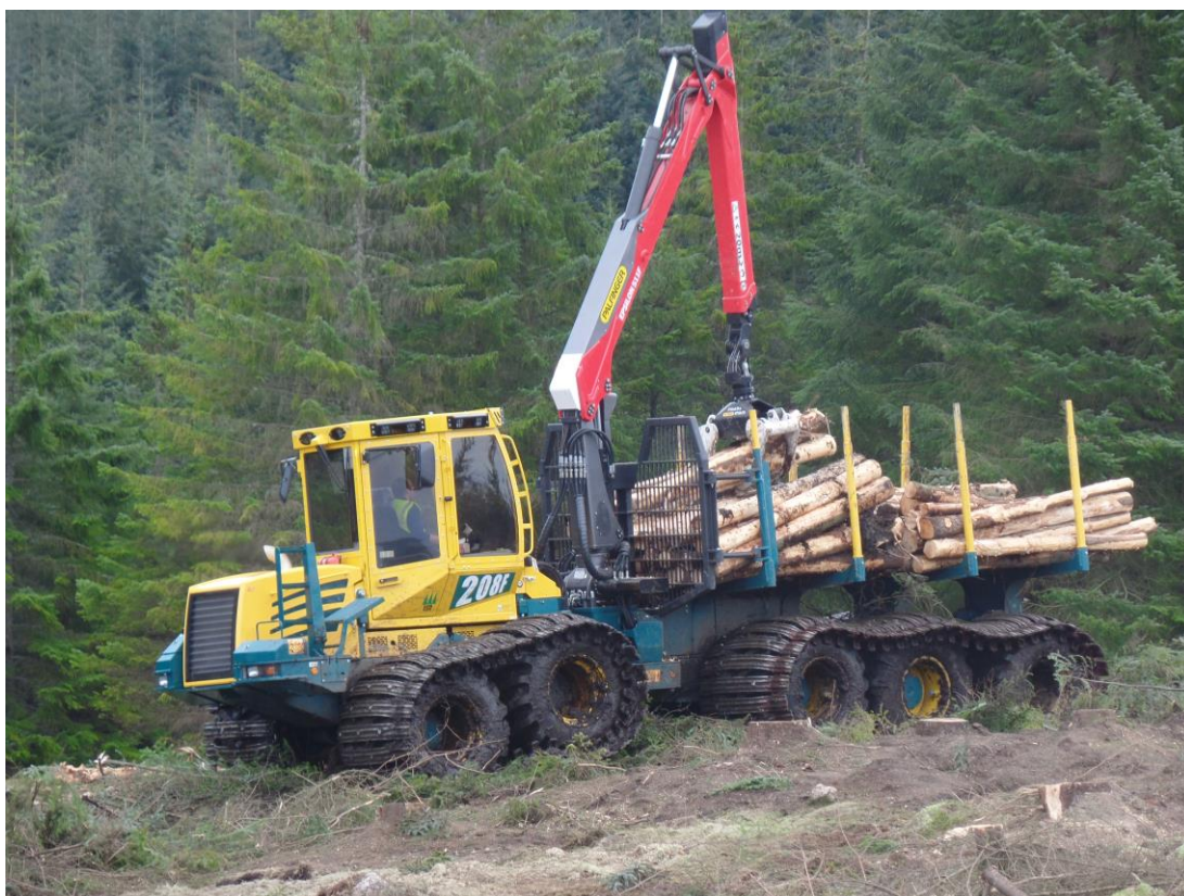
Primul prototip de tractor forwarder – testare în condiţii operaţionale reale
